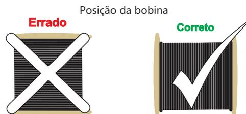
Não armazenar a bobina na posição Vertical
